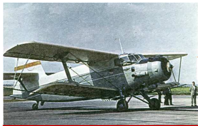
Многоцелевой транспортный самолет Ан-2. Разработан в ОКБ им. О.К. Антонова в 1946 году
